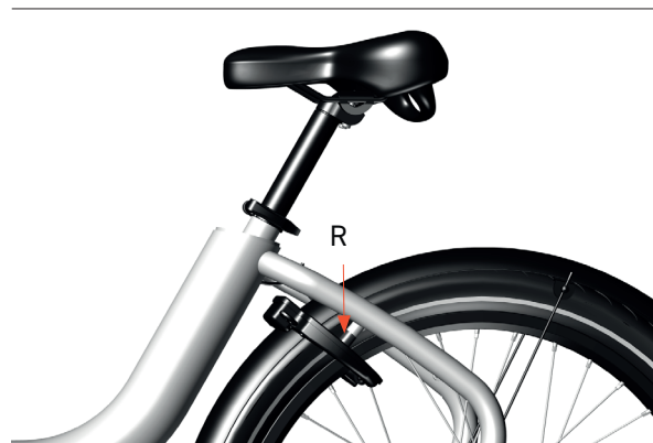
Afbeelding 37: De slotrubbers controleren
