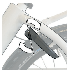
Image 26 : Tournez la clé de 20 à 30 degrés dans le sens des aiguilles d'une montre
