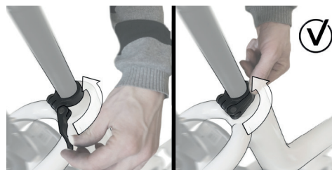
Abbildung 8 : Schließen des Schnellspanners der Sattelstütze
